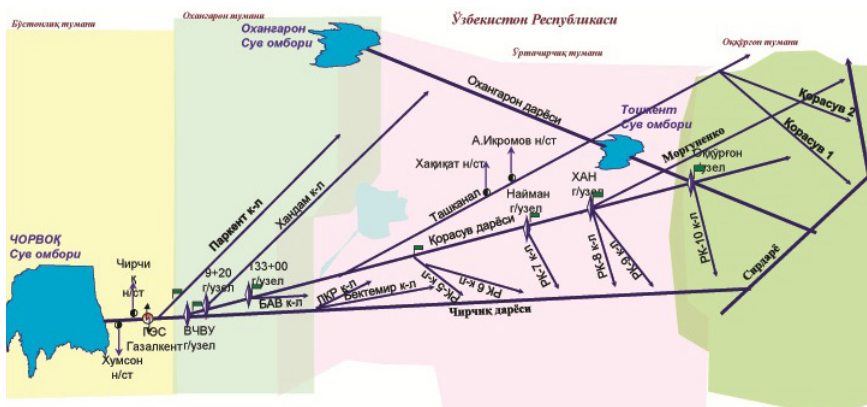
Рисунок 2.1. Линейная схема Ташкентского магистрального канала, каналов Паркентского и Хандам
