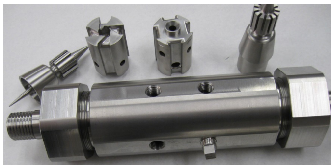
Рисунок 6. На рисунке показано устройство для аэродинамической активации топливной смеси с деталями прошедшими трансформацию по отношению к аэродинамическому генератору пены
