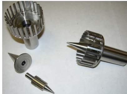
Рисунок 4. На рисунке показаны детали и компоненты аэродинамического генератора пены, которые при переходе к аэродинамическому гомогенному активированию топливных смесей трансформируются по геометрии, сохраняя соответствие основным конструктивным принципам
