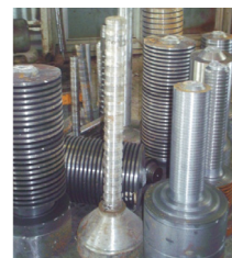
Рис. 3. Заготовки с кольцевыми канавками (с цилиндрическими или коническими рабочими шейками)
