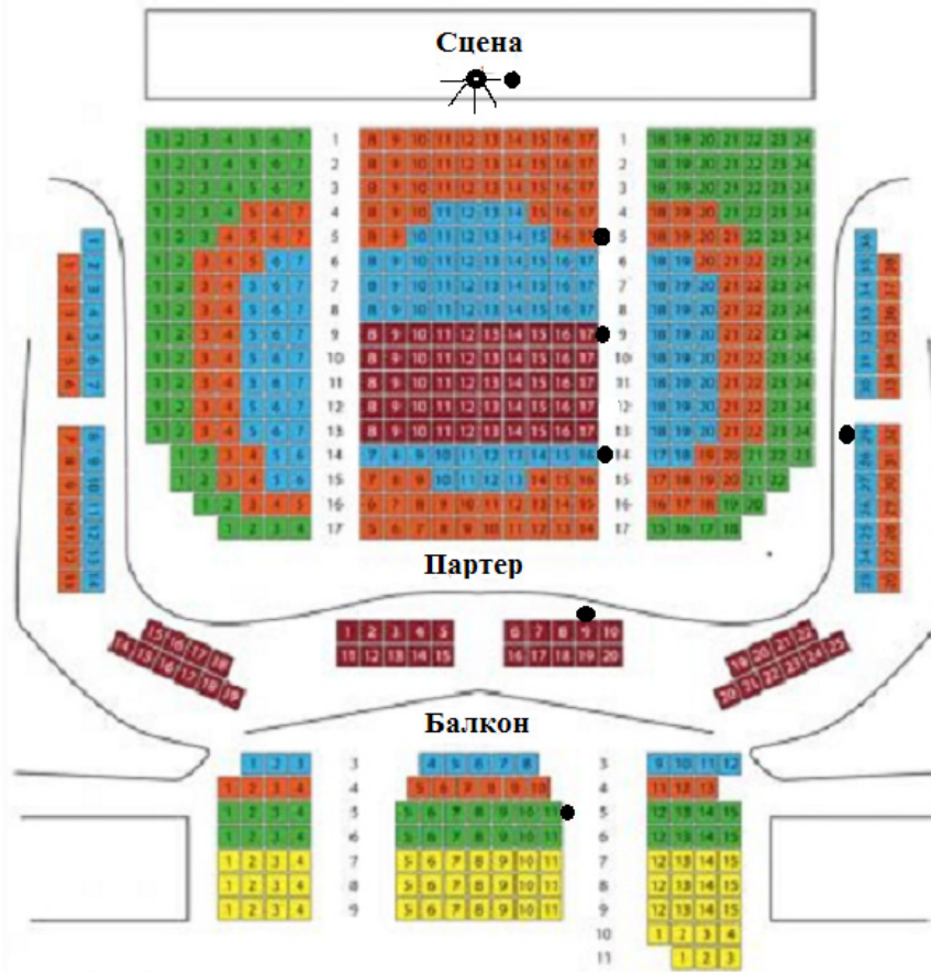
Рисунок 1. План концертного зала, места установок измерительных микрофонов и источника звукового сигнала
