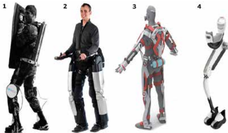
Рисунок 2. Типы экзоскелетов (1 – военный (защитный), 2 – медицинский, 3 – гражданский (спасательный), 4 – промышленный)
